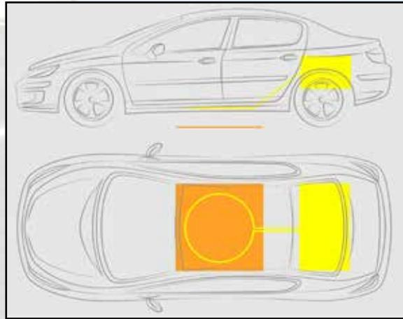
Die Induktionsspulen befinden sich auf der Fahrzeugunterseite und die Ladestationen im Erdboden. Alternativ kann sich die Spule vorne am Auto befinden und das Fahrzeug fährt vor die Ladestation. Dann ist der Abstand zwischen Spule und Ladestation nicht so groß und die Spulen müssen nicht so leistungsstark sein. Auch diese Art der Aufladung erfolgt noch über eine längere Zeit, z.B. über Nacht.
