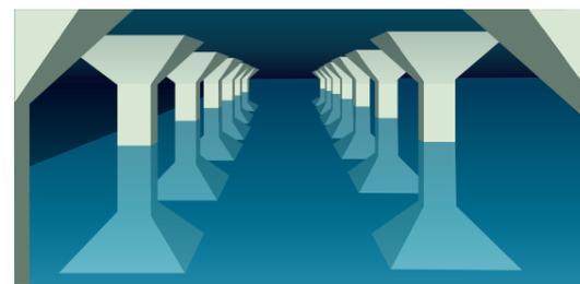
**Hochbehälter** sind riesige Zwischenspeicher, in denen das Wasser gesammelt wird. Da sie höher liegen als das Versorgungsgebiet, kann das Wasser mit seinem natürlichen Gefälle nach Nürnberg fließen.
